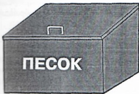
Ящик для песка должен иметь вместимость 0,5; 1,0 или 3,0 м 3 и комплектоваться совковой лопатой
